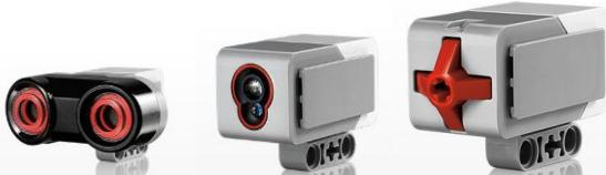
а) Датчик касания б) Ультразвуковой датчик с) Датчик цвета
