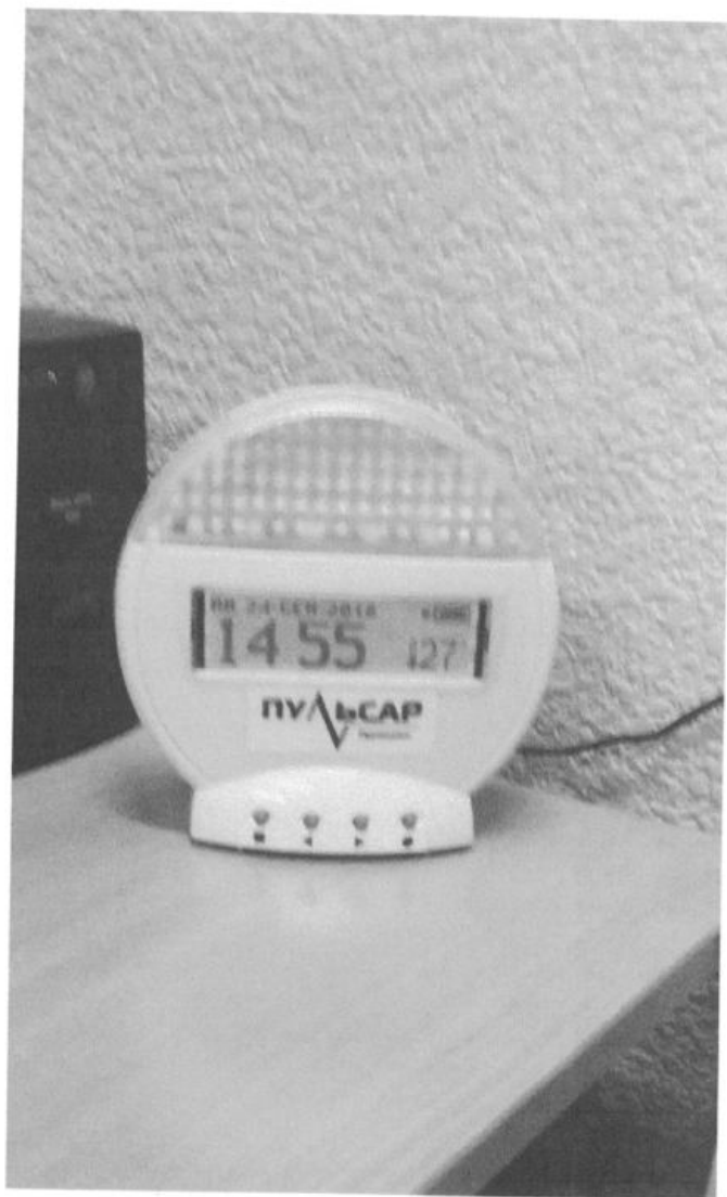
Фото № 18 гардероб - система оповещения персонала при нажатии на кнопки вызова персонала ул. Октябрьская, дом 12.
